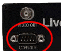
RS232C 仕様コネクタ D-SUB9 ピンプラグ(オン)
